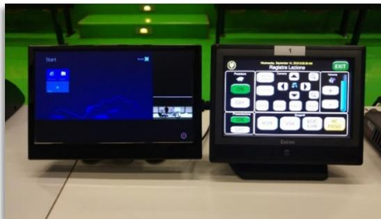
Figura 11: Schermi di controllo e anteprima della registrazione
